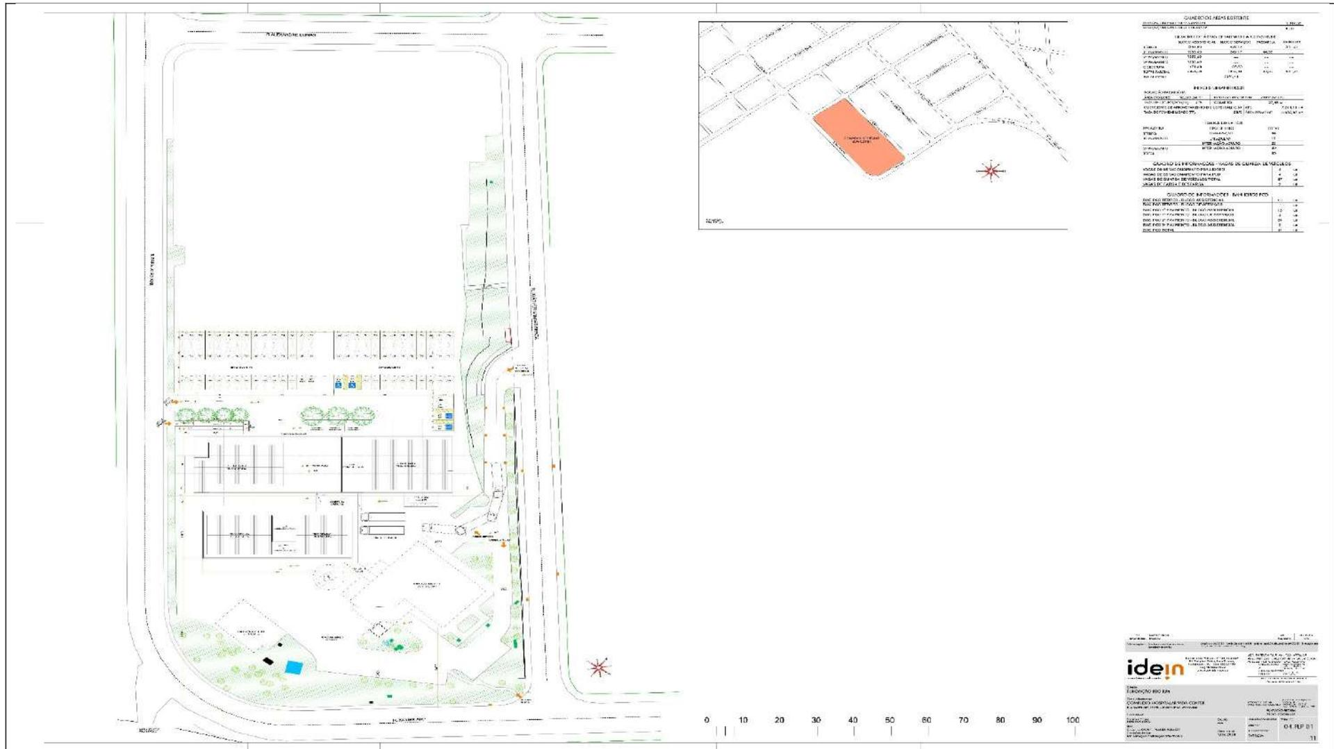
Plantas demarcando, no mínimo, os limites do imóvel, os acessos, as edificações existentes, a demolir, a construir, a regularizar, as alturas, as áreas permeáveis, as vagas de estacionamento, de visitantes, de embarque e desembarque, de carga e descarga, com indicação do norte, escala gráfica e legenda.
