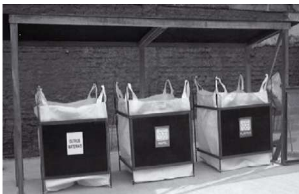
Figura 6-4 - Utilização de bags para armazenamento de resíduos
