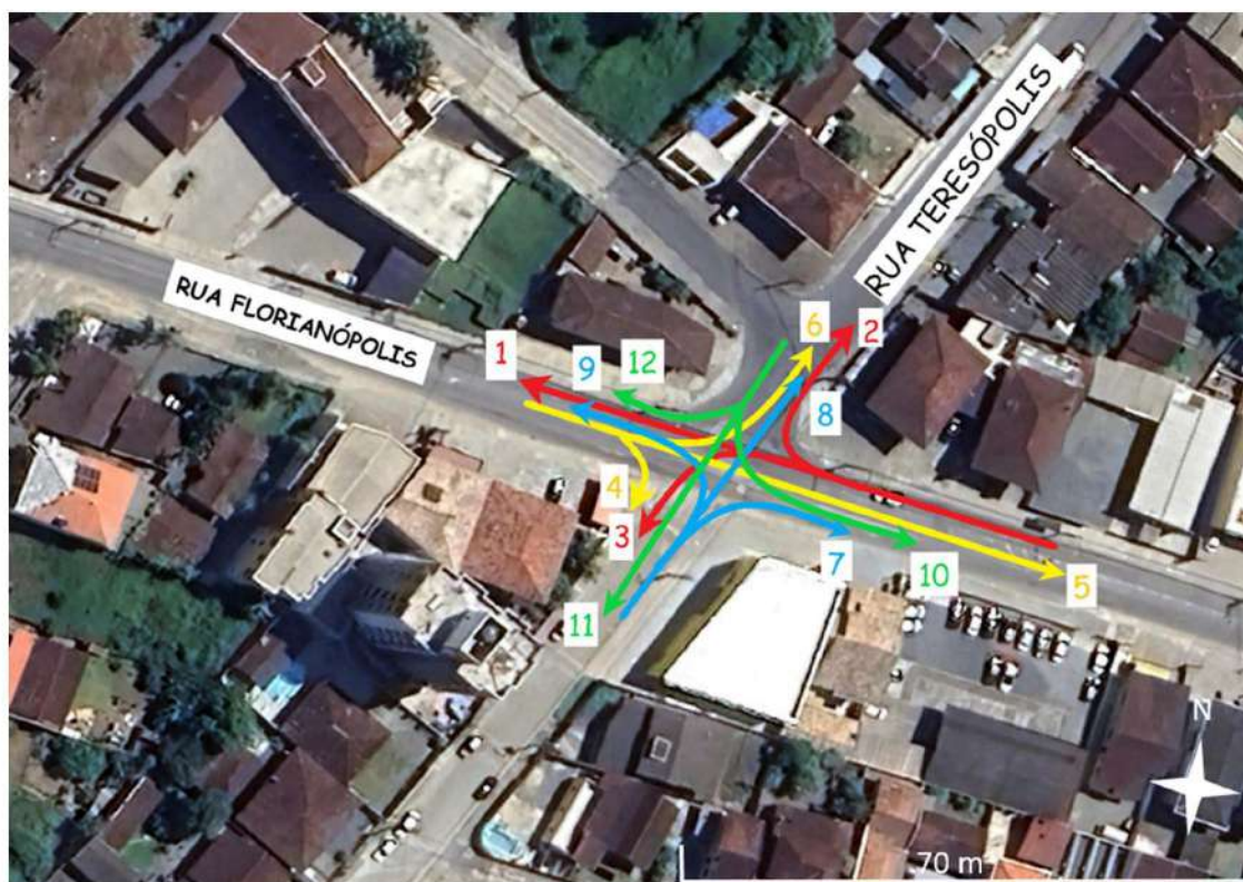
Figura 45: Fugira ilustrativa evidenciando o ponto de interseção da Rua Teresópolis com Rua Florianópolis e seus respectivos sentidos de contagem. Fonte: DBio, 2024.
