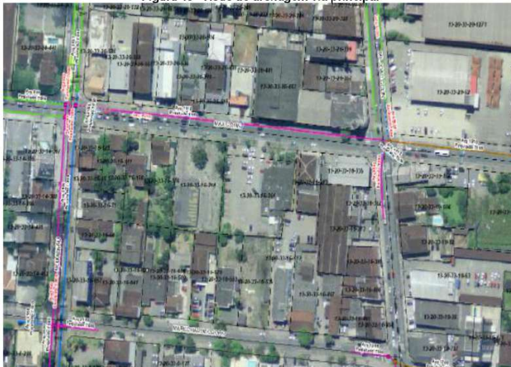
Figura 13 - Rede de drenagem via principal
