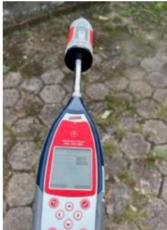
Figura: Calibração do equipamento no local das medições
