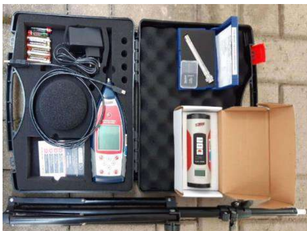
Foto 10-20: Detalhe do sonômetro (decibelímetro), modelo DEC 6000, utilizado na campanha de monitoramento.
