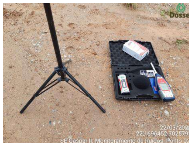
Foto 10-23: Tripé, sonômetro (decibelímetro) modelo DEC 6000, e calibrador de nível sonoro utilizados no monitoramento.
