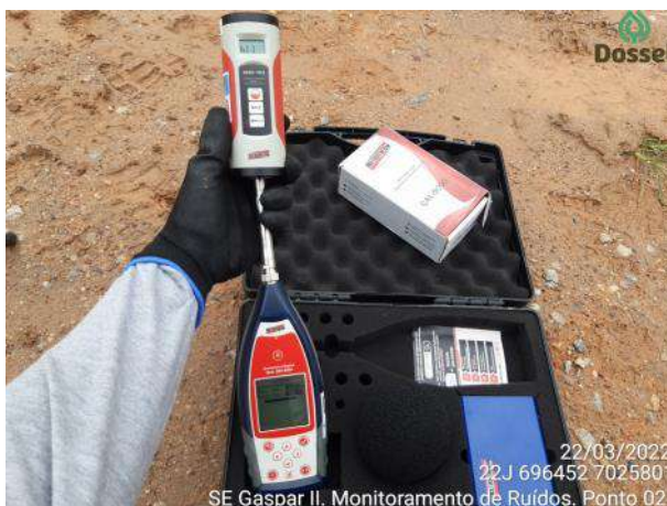
Foto 10-22: Sonômetro (decibelímetro) modelo DEC 6000 e registro da calibração em campo, antes do início do monitoramento de ruídos.
