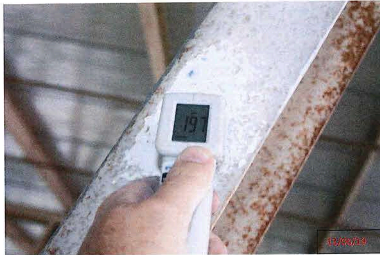
Foto 2 – Medição de espessura de Tinta
