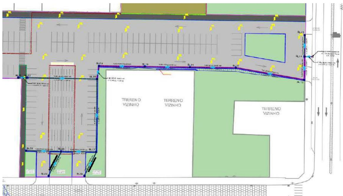
**Figura 4.5 -** Projeto de drenagem - aproximado na área de estacionamento.
