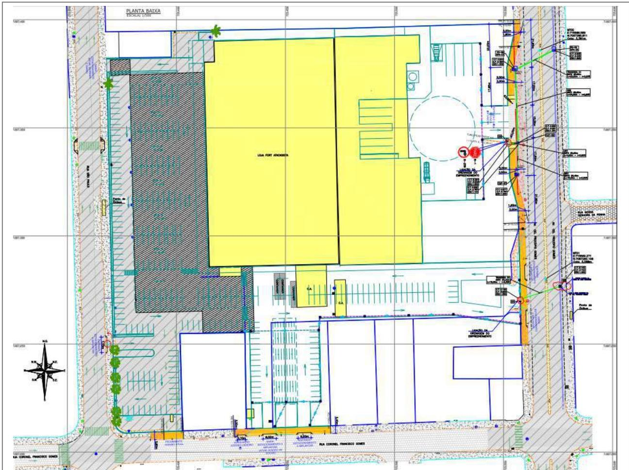
**Figura 4.1** - Projeto em andamento de acesso, com faixa de aceleração na Av. Procópio Gomes.
