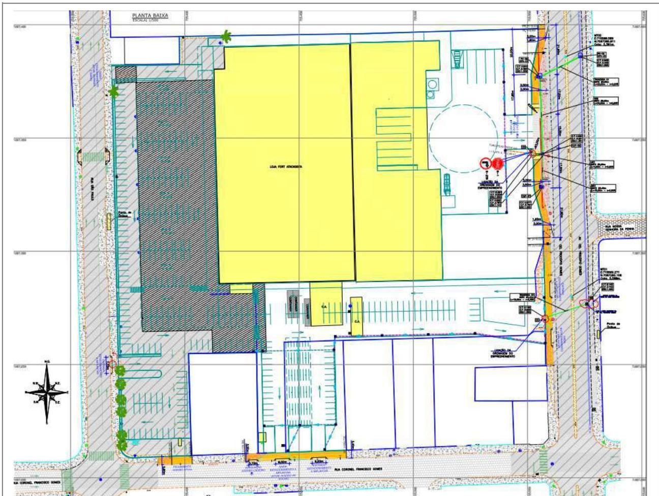
**Figura 4.25** - Projeto de acesso, com faixa de aceleração na Av. Procópio Gomes.
