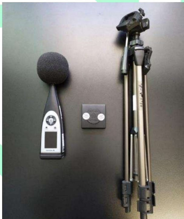
Figura 42: Equipamentos utilizados para medição de ruído.
