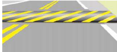
Figura 64: Ondulação transversal para redução de velocidade.
