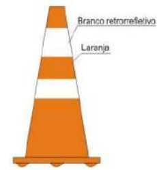
Figura 65: Modelo de cone para o bloqueio temporário de fluxo de veículos.
