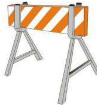
Figura 67: Exemplo de barreira móvel com cavalete.
