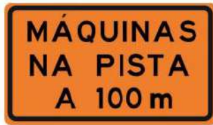
Figura 63: Indicação de obras à frente.
