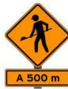
Figura 62: Indicação de obras à frente.
