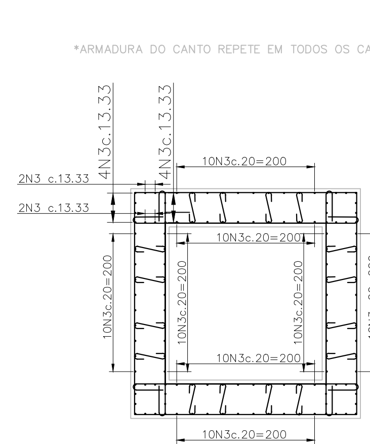
ARMADURA DO COFRE esc 1:50
