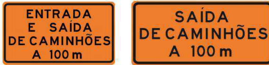
Figura 70: Modelos de placas informativas para entra e saída de veículos da obra.
