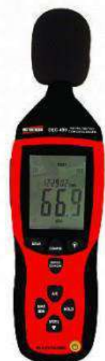
Figura 29: Medidor de Nível Sonoro. Fonte: Instrutherm.
