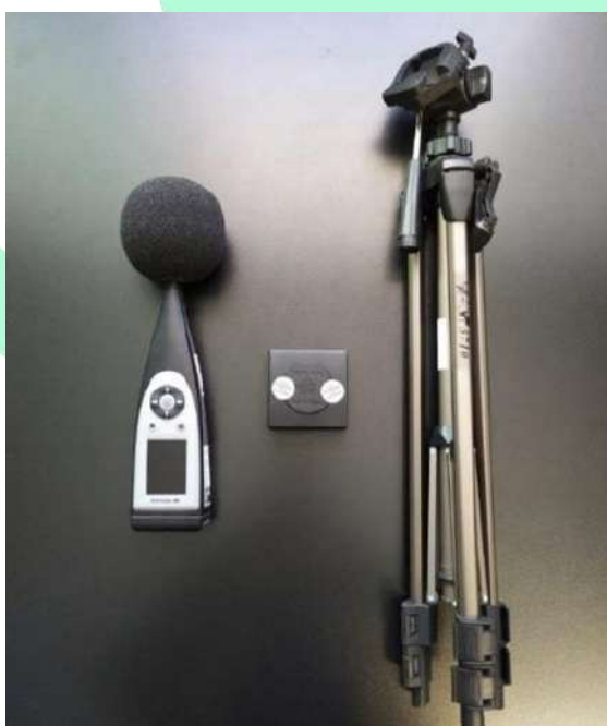
Figura 42: Equipamentos utilizados para medição de ruído.
