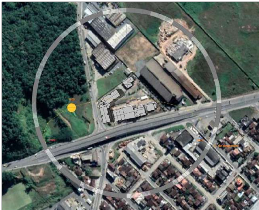
Figura 43. Incidência solar no solstício de verão (21 de dezembro), as 15h da tarde Fonte: Doré Engenharia, 2022.
