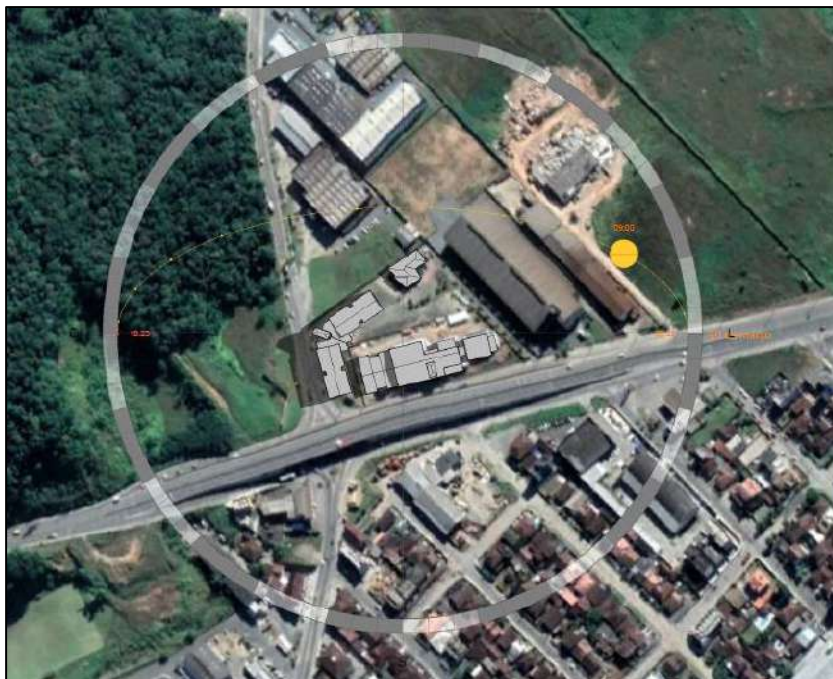
Figura 45. Incidência solar no equinócio de outono (20 de março), as 09h da manhã Fonte: Doré Engenharia, 2022.
