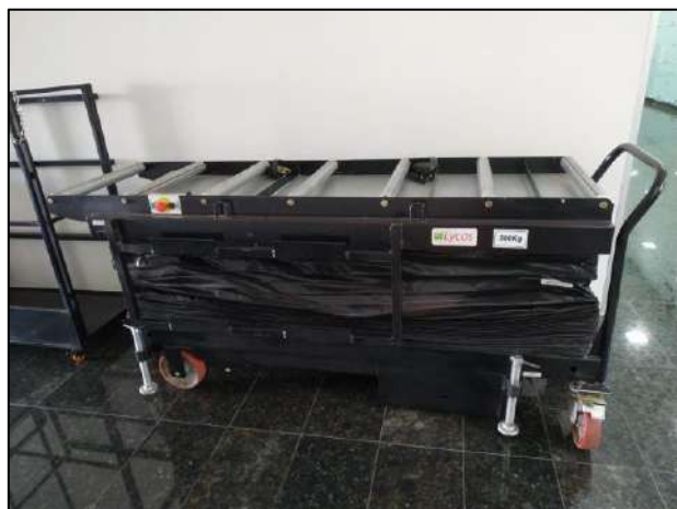
Figura 12. Mesa elevatória utilizada no Cemitério Vertical de Maringá. 2022. Fonte: Doré Engenharia, 2022.
