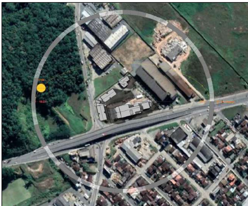
Figura 47. Incidência solar no equinócio de outono (20 de março), as 17h da tarde Fonte: Doré Engenharia, 2022.
