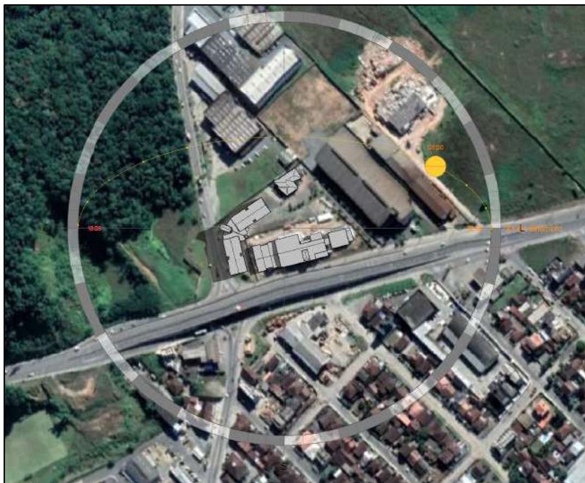
Figura 39. Incidência solar no equinócio de primavera (23 de setembro), as 09h da manhã Fonte: Doré Engenharia, 2022.
