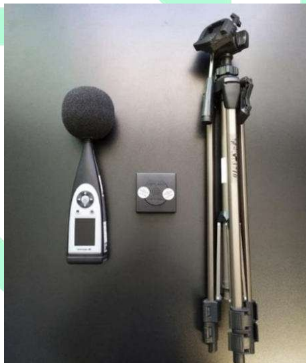
Figura 42: Equipamentos utilizados para medição de ruído.
