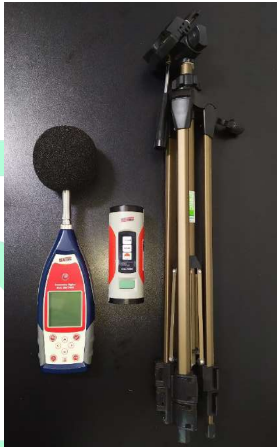
Figura 41: Equipamentos utilizados para medição de ruído (Sonômetro Instrutherm DEC – 7000, Calibrador Instrutherm modelo CAL-5000 e Tripé).
