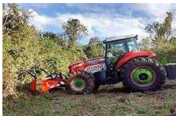
Foto 6-11: Desbastador florestal frontal acoplado à dianteira de trator agrícola. Fonte: Google, 2020.
