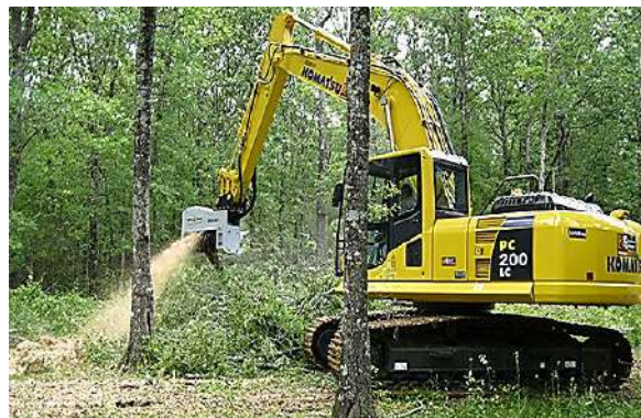
Foto 6-9: Desbastador florestal braços articulados acoplado à escavadeira de esteira. Fonte: Google, 2020.
