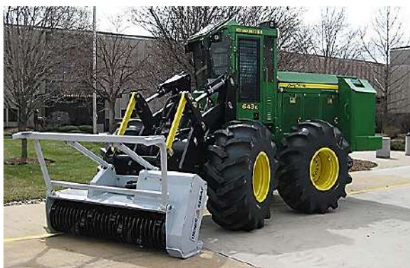
Foto 6-6: Desbastador florestal frontal acoplado à Skidder.
