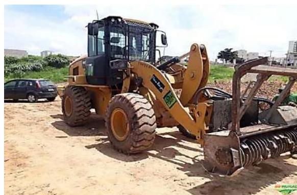
Foto 6-7: Desbastador florestal frontal acoplado à carregadeira de direção.
