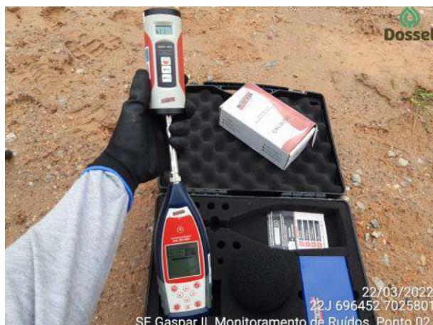
Foto 3-3: Sonômetro (decibelímetro) modelo DEC 6000 e registro da calibração em campo, antes do início do monitoramento de ruídos.
