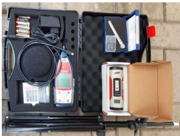
Foto 3-1: Detalhe do sonômetro (decibelímetro), modelo DEC 6000, utilizado na campanha de monitoramento.
