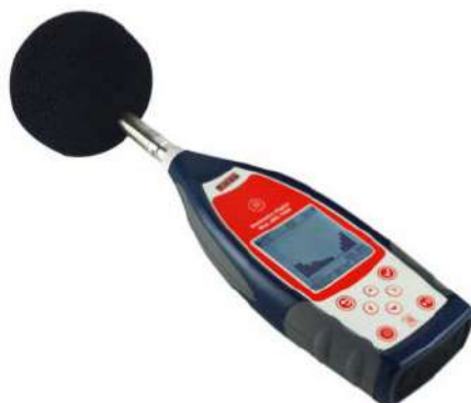
Figura 2-16: Exemplo de sonômetro (medidor integrador de nível sonoro) com filtro de banda de oitava classe 1, em atendimento à IEC 61672.
