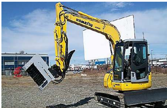
Foto 6-8: Desbastador florestal para braços articulados acoplado à escavadeira compacta de esteira. Fonte: Google, 2020.
