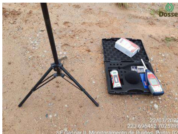
Foto 3-4: Tripé, sonômetro (decibelímetro) modelo DEC 6000, e calibrador de nível sonoro utilizados no monitoramento.
