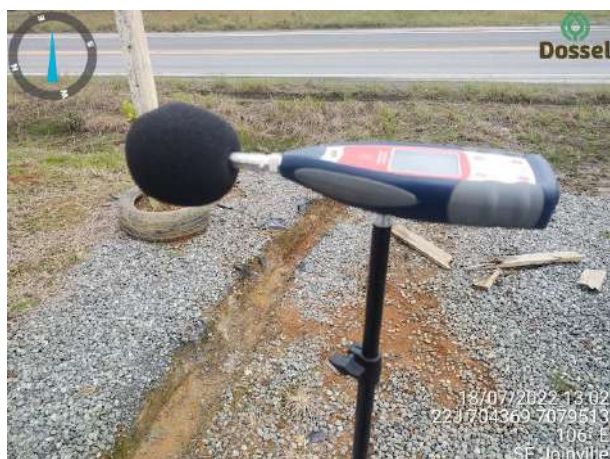
Foto 7-7: Ponto 04 do monitoramento de ruídos na SE Joinville Sul. Data: 18/07/2022.
