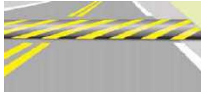
Figura 64: Ondulação transversal para redução de velocidade.
