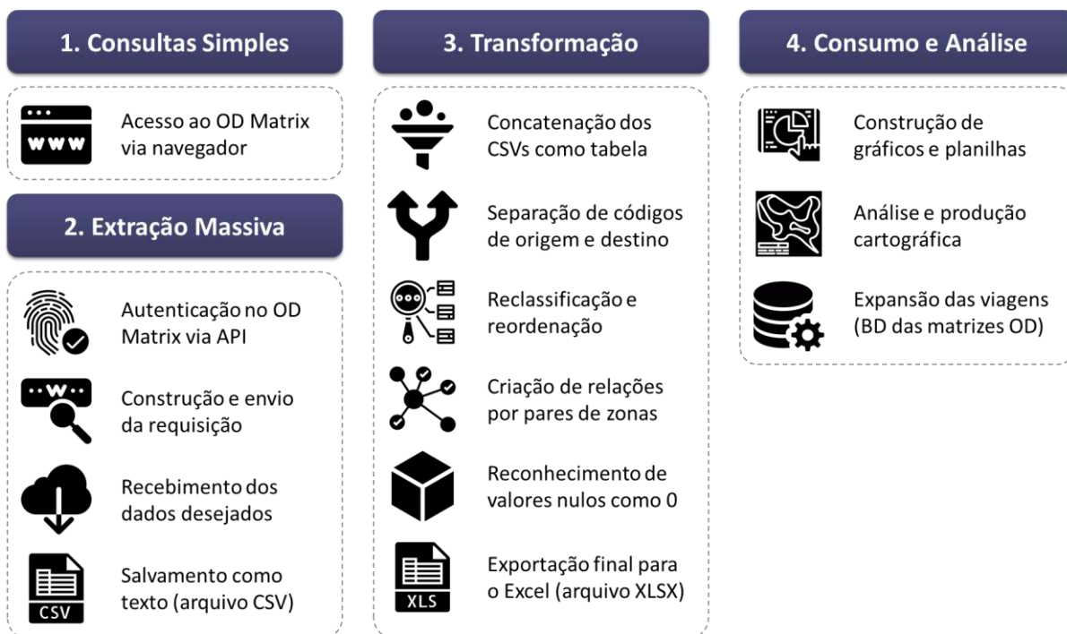
Figura 12 – Diagrama das etapas associadas à utilização dos dados de origem e destino da plataforma OD Matrix
