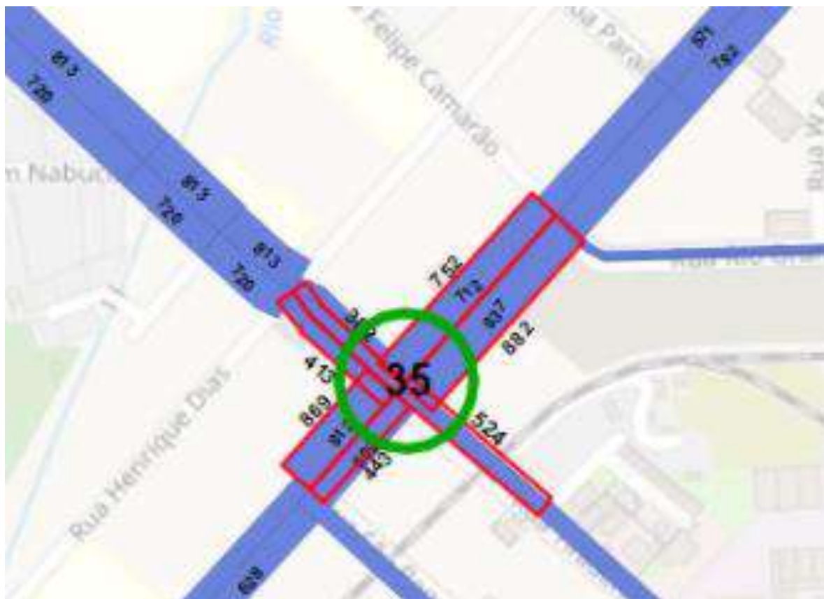
Figura 16 – Exemplo de verificação de valores expandidos e pontos de CVC.
