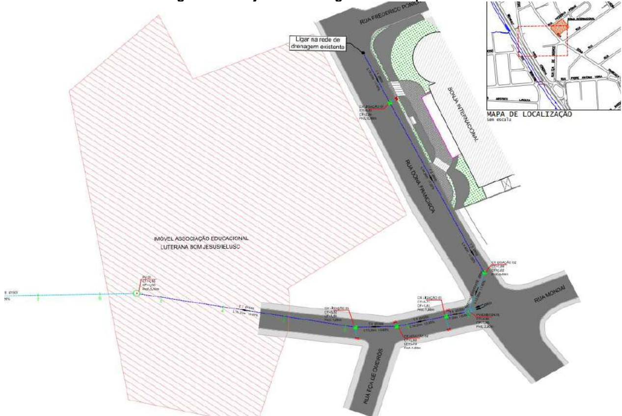
Figura 38- Projeto de drenagem de rede pluvial.
