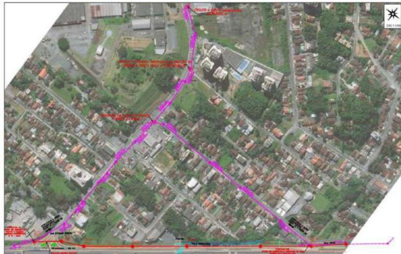
Planta de realocação da rede elétrica de alta tensão
