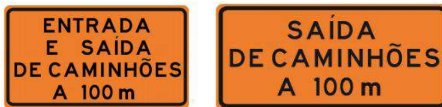
Figura 71: Modelos de placas informativas para entra e saída de veículos da obra.
