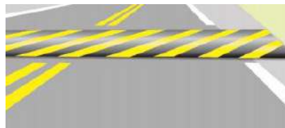
Figura 65: Ondulação transversal para redução de velocidade.
