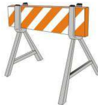
Figura 68: Exemplo de barreira móvel com cavalete.
