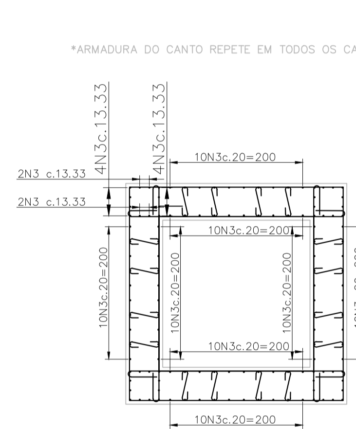
ARMADURA DO COFRE esc 1:50
