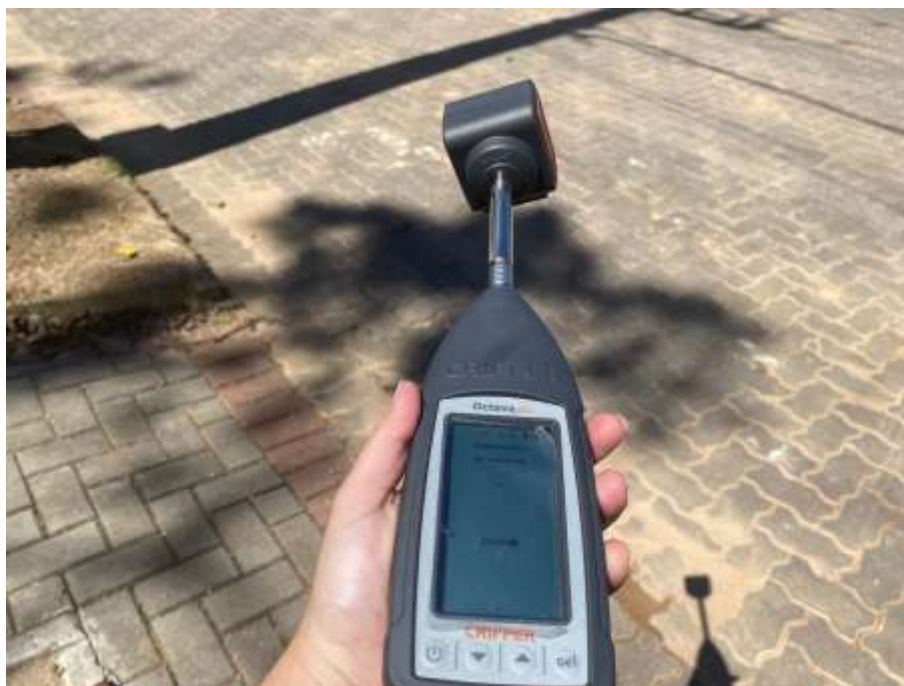
Figura 02: Calibração realizada in loco , antes das aferições. Fonte: Pense Verde CSA. Registro em 20/09/2022.
