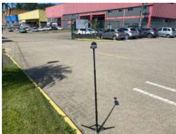
Figura 07: Aferição do nível de pressão sonora no PES -05. Fonte: Pense Verde CSA.
