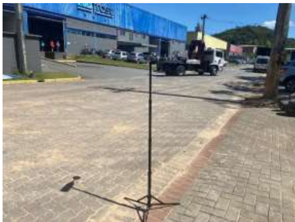
Figura 03: Aferição do nível de pressão sonora no PES -01. Fonte: Pense Verde CSA.
