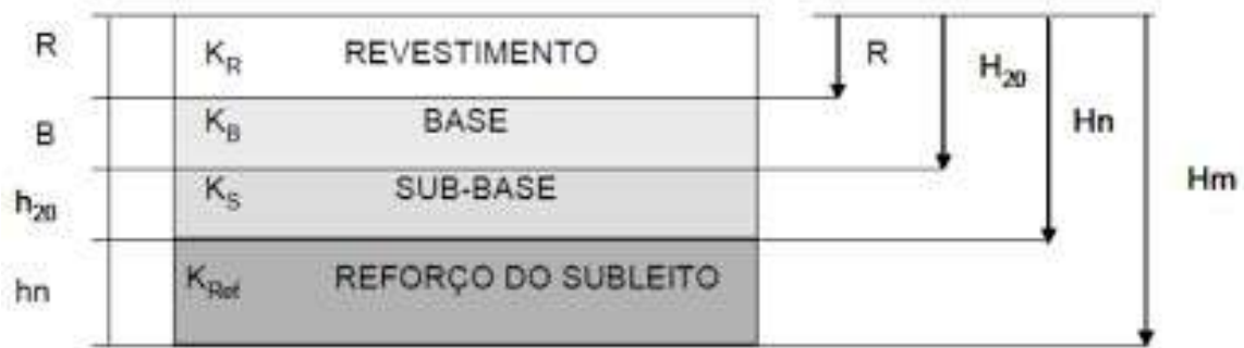
Figura 03. Dimensionamento de pavimento flexível
