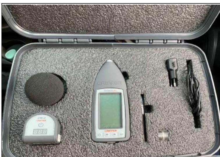
Figura 1.1.5.1: Modelo de Sonômetro marca: Criffer Octava Plus.
