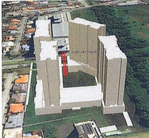
Figura 8: Visualização de efeito canalização devido a presença de três andares direcionando o fluxo do vento por uma canal a céu aberto sentido (norte – sul).
