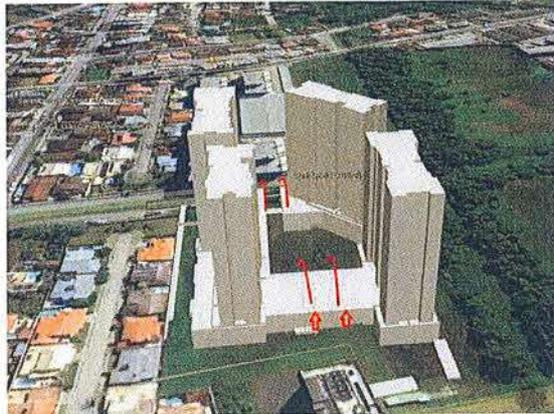
Figura 5: Visualização de efeito barreira devido a presença de três andares impedindo o fluxo do vento, o desviando em espiral para ventilação sentido (norte – sul).
