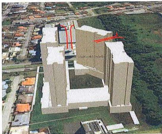
Figura 7: Visualização de efeito venturi devido a proximidade dos edifícios.
