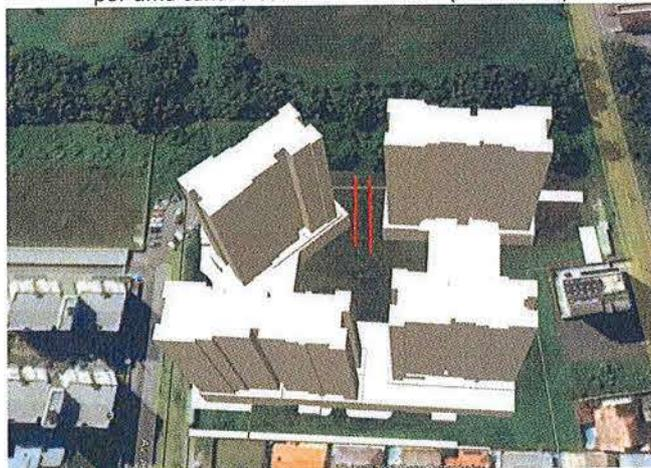
Figura 9: Visualização de efeito canalização devido a presença de três andares direcionando o fluxo do vento por uma canal a céu aberto sentido (leste - oeste).
