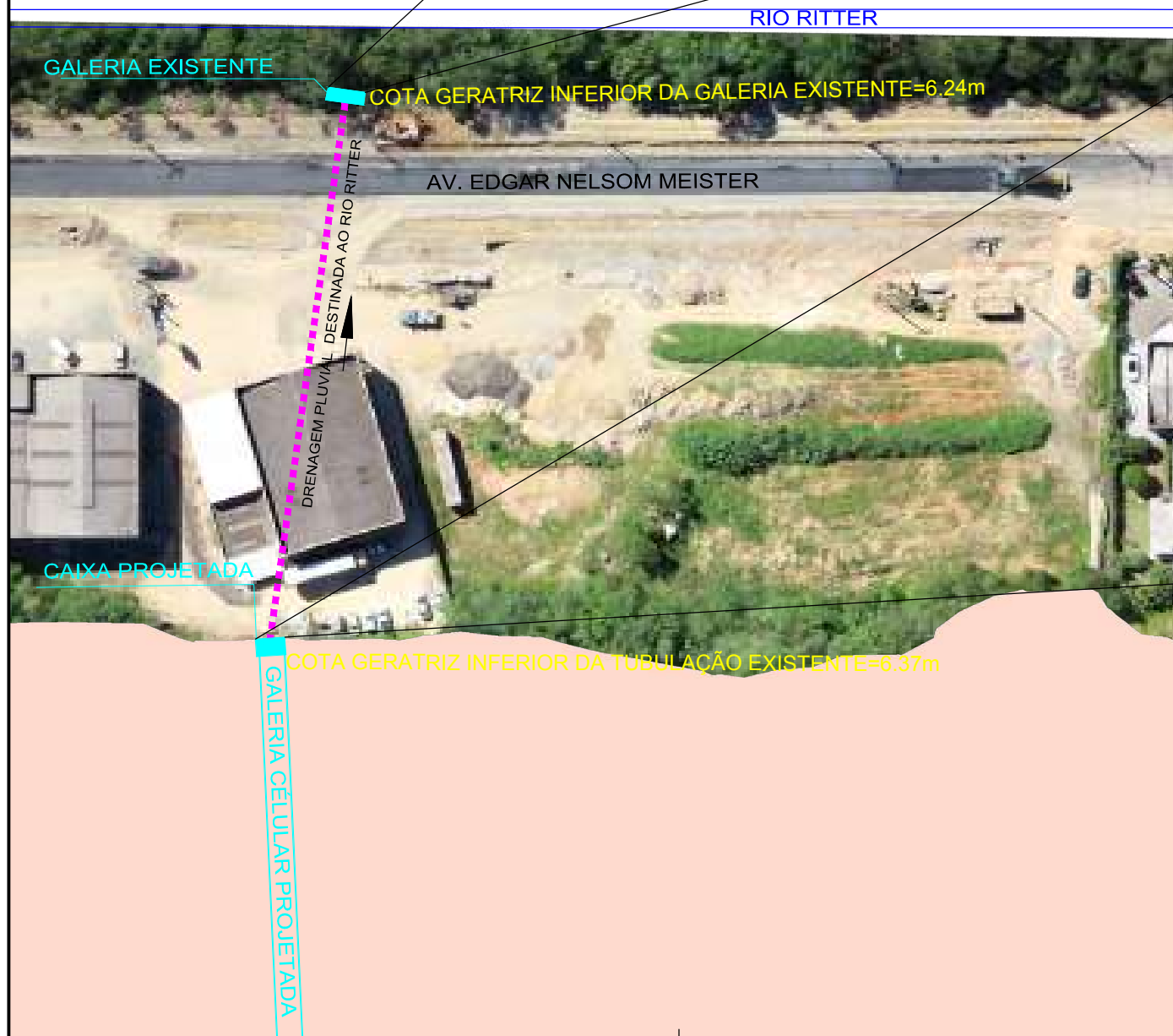
TUBULAÇÃO EXISTENTE DE \varnothing=2,30\text{m} NA ÁREA DA ASCENSUS, QUE SERÁ CONECTADA NA CAIXA DE DRENAGEM PROJETADA.
