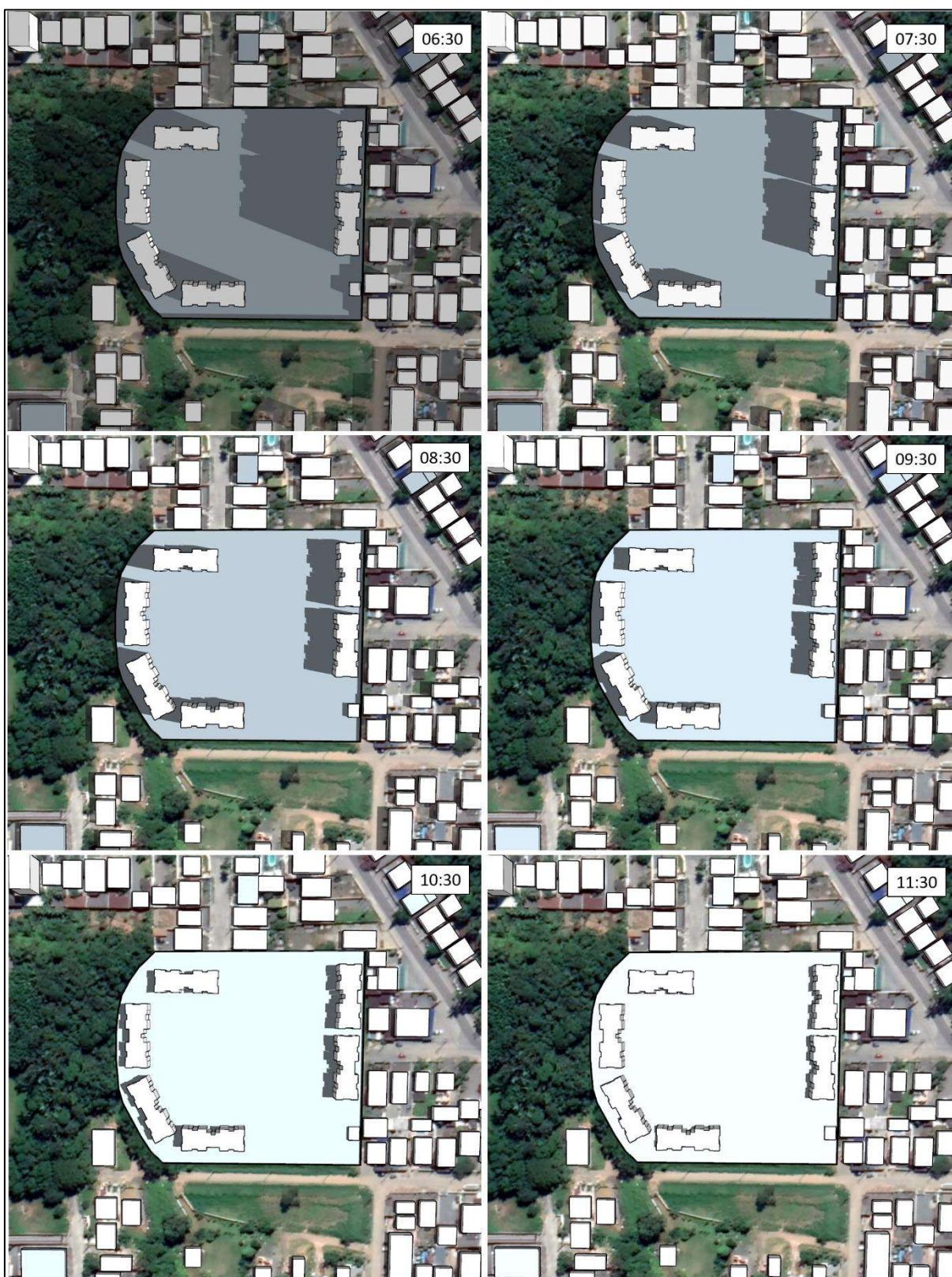
Figura 23. Compilado de imagens evidenciando o sombreamento projetado para o futuro empreendimento durante o Solstício de Verão para o período matutino. Fonte: DBio, 2021.
