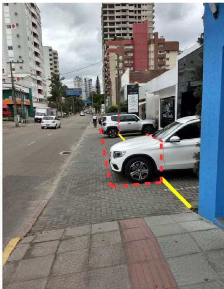
Figura 1: veículos estacionados sobre o passeio por tamanho insuficiente do recuo para receber a vaga de estacionamento. As linhas amarelas definem o limite entre recuo e calçada. As linhas vermelhas evidenciam o avanço sobre o passeio.
