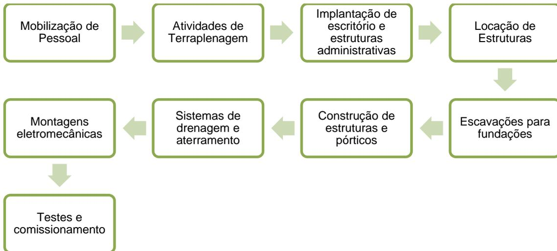
Figura 1: Atividades da construção de uma Subestação.
