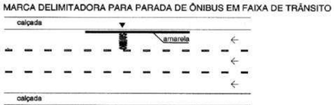
Figura 79: Exemplos de marcas longitudinais. Fonte: Detran/SC.
