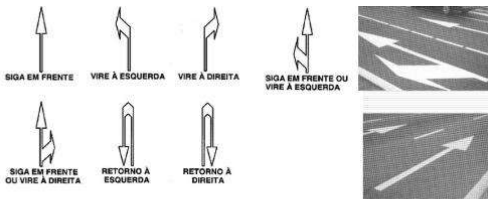
Figura 80: Exemplos de marcas longitudinais. Fonte: Detran/SC.
