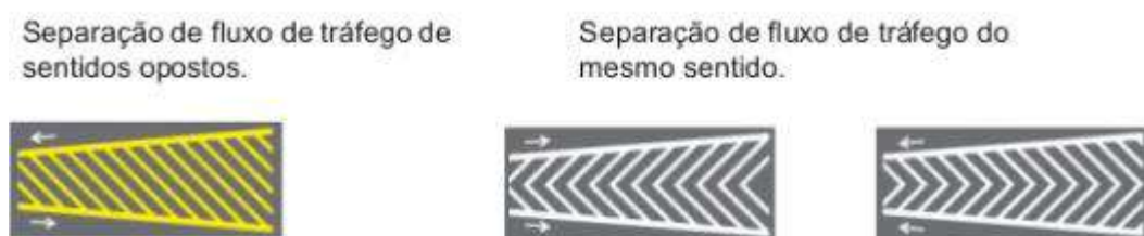
Figura 78: Exemplos de marcas longitudinais. Fonte: Detran/SC.
