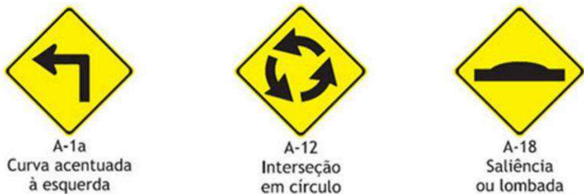
Figura 73: Exemplos de placas de Advertência. Fonte: Detran/SC
