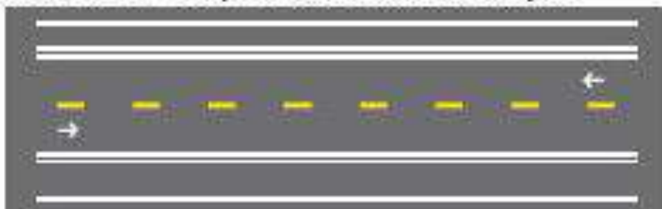
Figura 76: Exemplos de marcas longitudinais. Fonte: Detran/SC
