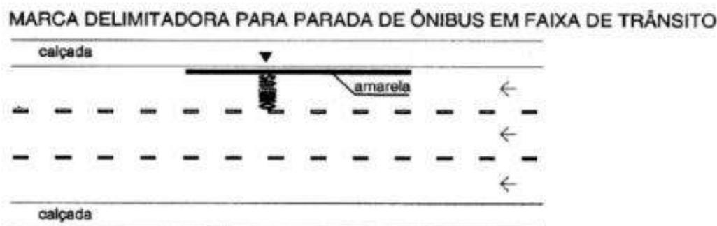
Figura 76: Exemplos de marcas longitudinais. Fonte: Detran/SC.
