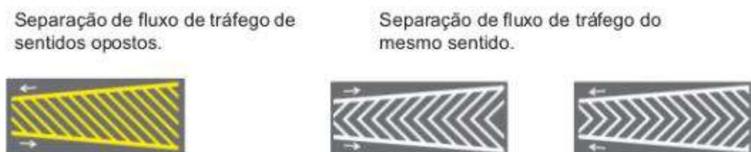
Figura 75: Exemplos de marcas longitudinais. Fonte: Detran/SC.
