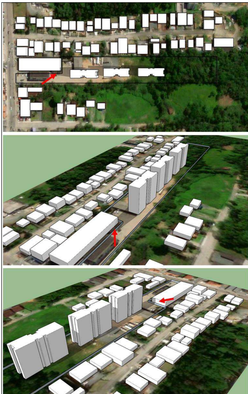
Figura 25. Três formas para visualização do sombreamento durante o equinócio de verão (21/12 – 09:00). A ausência das setas indicam o não sombreamento dos imóveis vizinhos neste período. Fonte: DBio, 2020.
