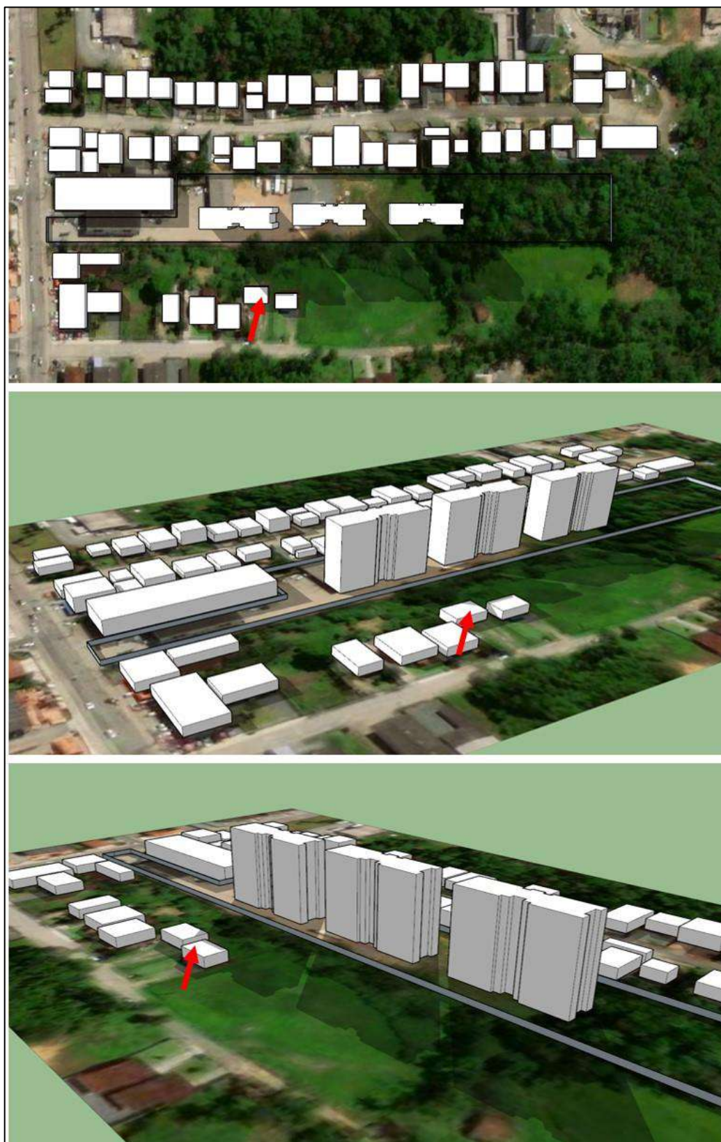
Figura 22. Três formas para visualização do sombreamento durante o solstício de inverno (20/06 – 15:00). Setas em vermelho destacam as áreas de imóveis vizinhos afetadas pelo sombreamento e quadrados pontilhados indicam a extensão da área impactada. Fonte: DBio, 2020.
