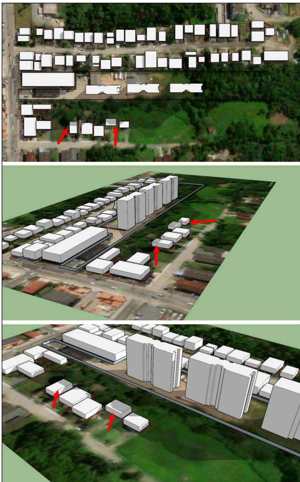
Figura 21. Três formas para visualização do sombreamento durante o solstício de inverno (20/06 – 09:00). Setas em vermelho destacam as áreas de imóveis vizinhos afetadas pelo sombreamento e quadrados pontilhados indicam a extensão da área impactada. Fonte: DBio, 2020.
