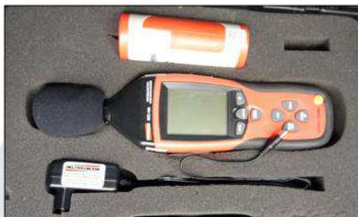
Figura 67. Medidor de Nível Sonoro e Calibrador de Nível Sonoro.
