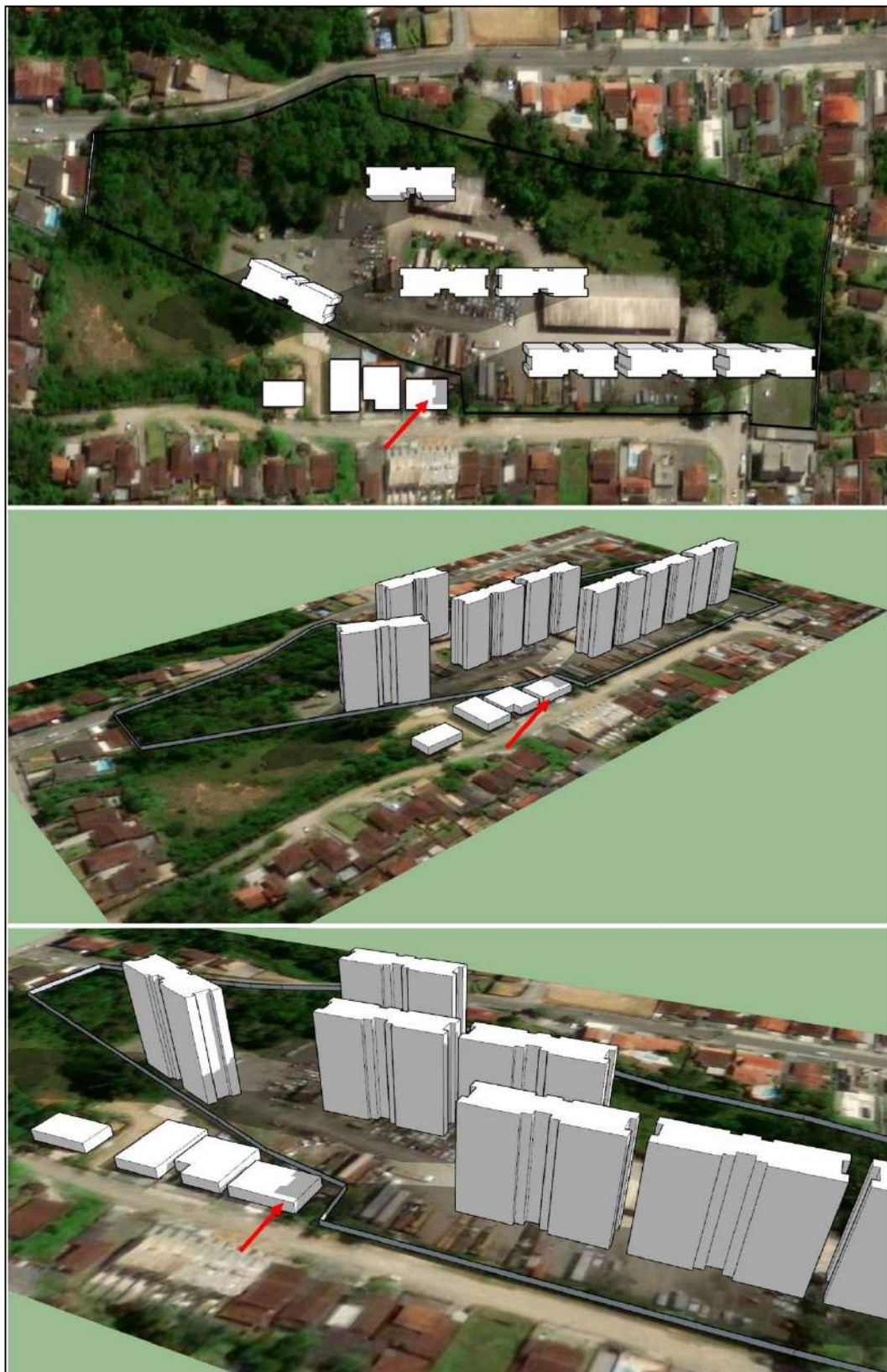
Figura 21: Três formas para visualização do sombreamento durante o equinócio de verão (20/03 – 09:00). Setas em vermelho destacam as áreas de imóveis vizinhos afetadas pelo sombreamento. Fonte: DBio, 2020.
