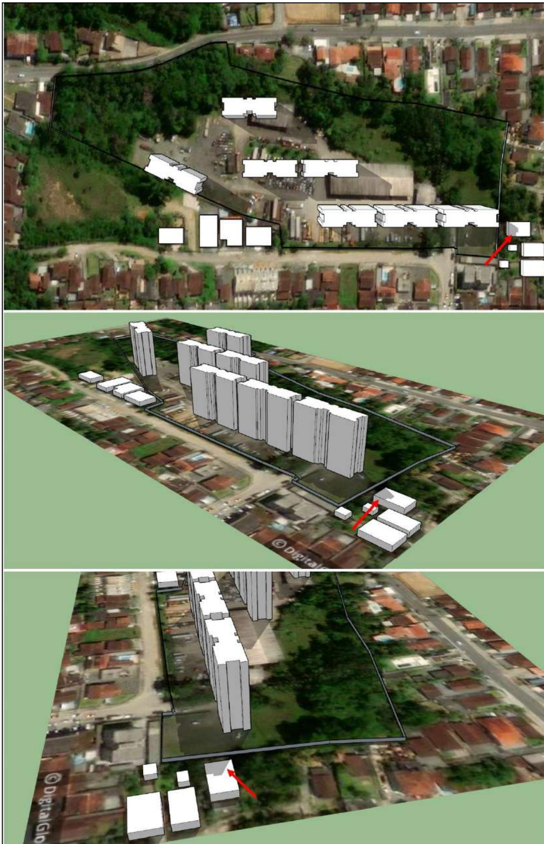
Figura 22: Três formas para visualização do sombreamento durante o equinócio de verão (20/03 – 15:00). Setas em vermelho destacam as áreas de imóveis vizinhos afetadas pelo sombreamento. Fonte: DBio, 2020.
