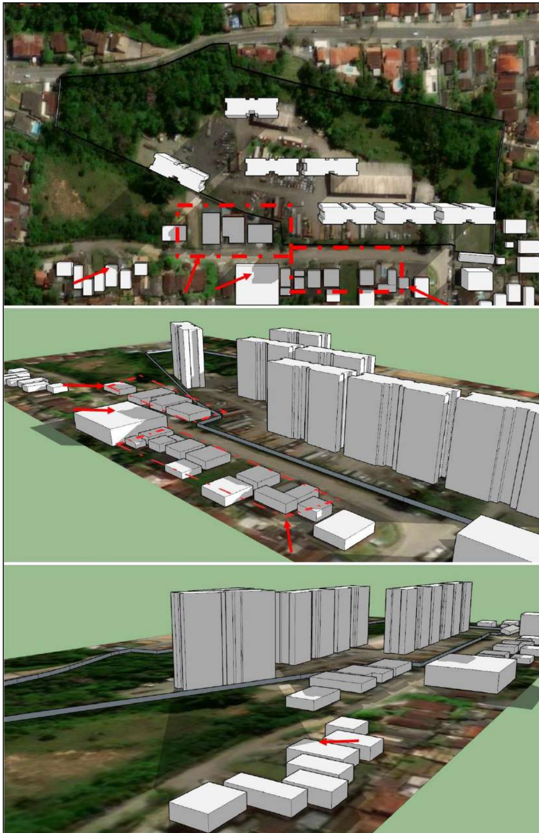
Figura 23: Três formas para visualização do sombreamento durante o solstício de inverno (20/06 – 09:00). Setas em vermelho destacam as áreas de imóveis vizinhos afetadas pelo sombreamento e quadrados pontilhados indicam a extensão da área impactada. Fonte: DBio, 2020.
