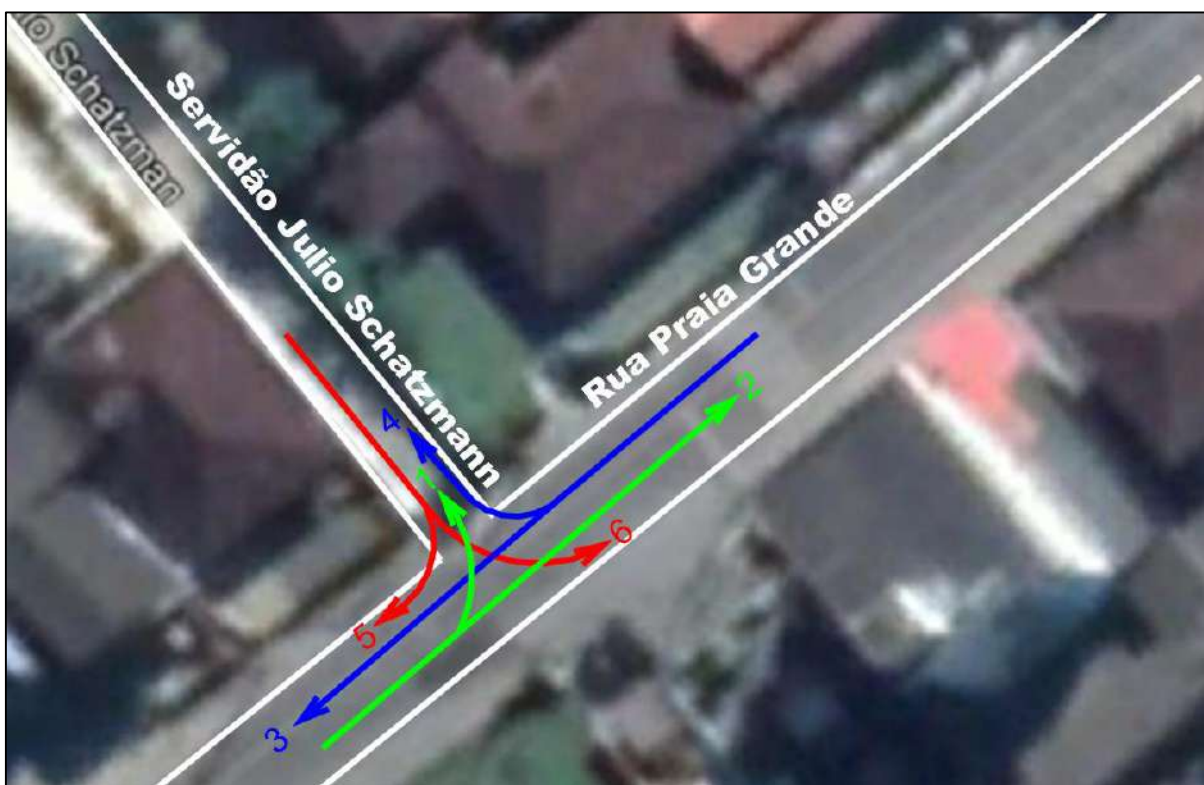
Figura 46. Croqui de movimentos na interseção da Rua Praia Grande com a Servidão Julio Schatzmann em Joinville/SC para o ano de 2019. Fonte: DBio, 2020.
