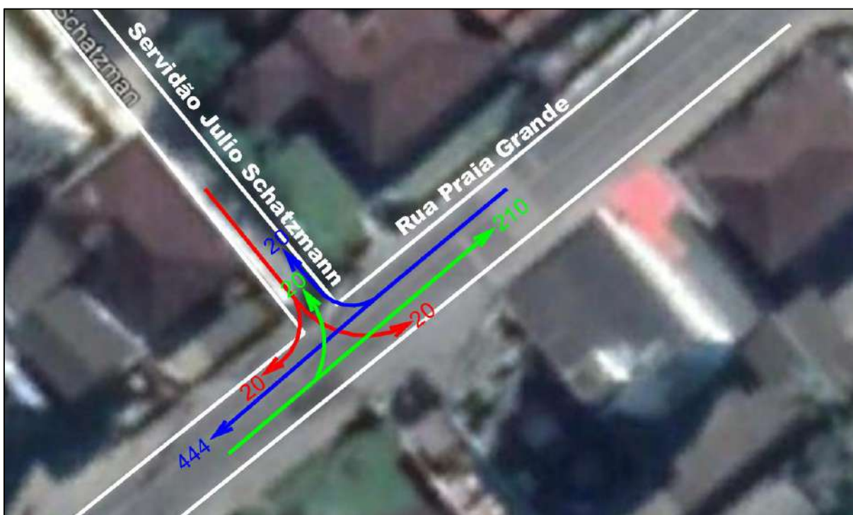
Figura 47. Croqui de movimentos e volumes de tráfego na interseção da Rua Praia Grande com a Servidão Julio Schatzmann em Joinville/SC para o ano de 2019. Fonte: DBio, 2020.
