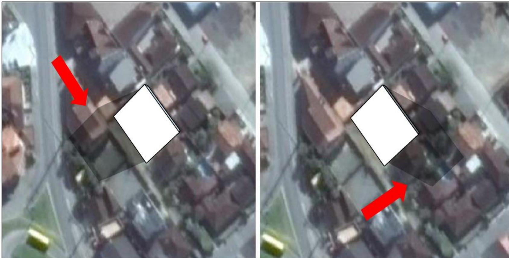
Figura 19: Sombreamento durante o equinócio de inverno (23/09 – 09:00 e 15:00). Fonte: DBio, 2020.
