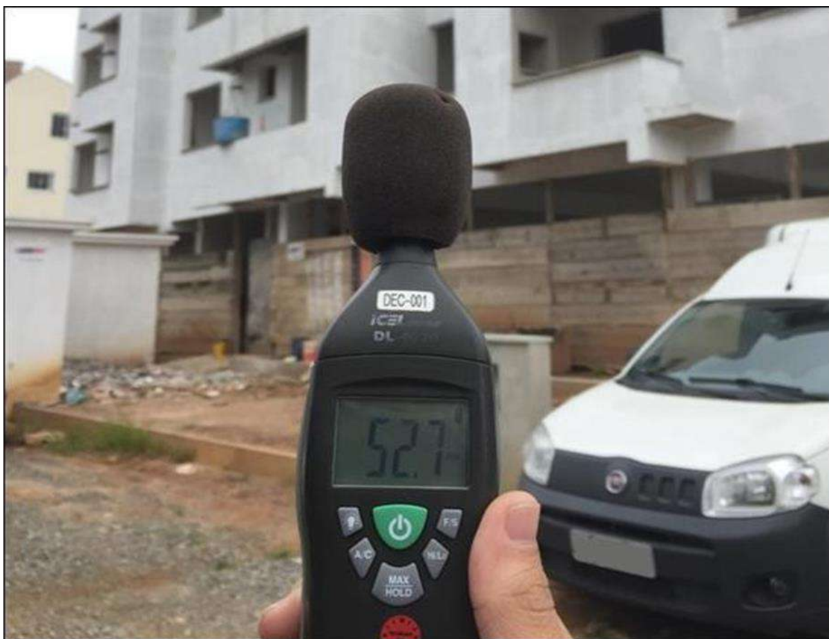
Figura 56. Equipamento utilizado para mensuração do nível de pressão sonora no entorno do imóvel. Autor: Dbio, 2020.
