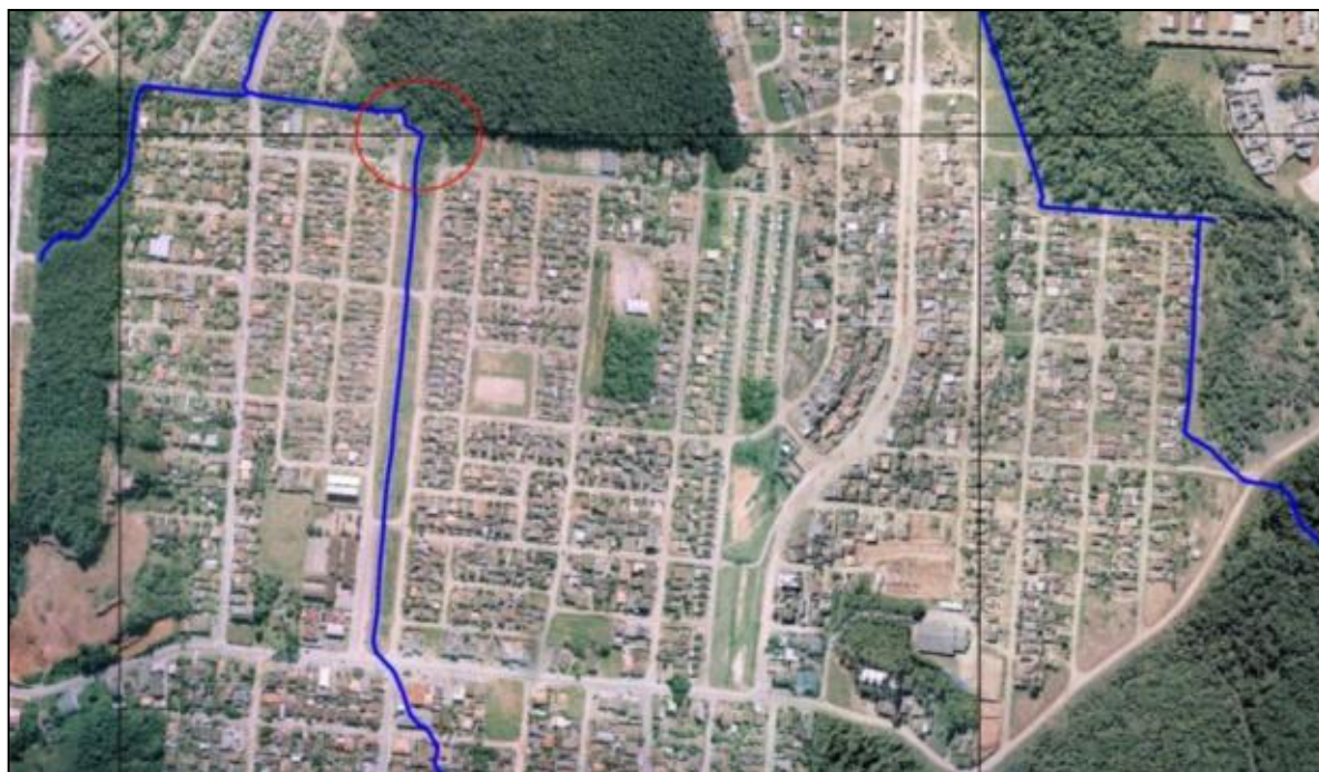
Figura 4.5 – Rio Itaum Mirim - Curvas a 90° implantada na rede de drenagem.
