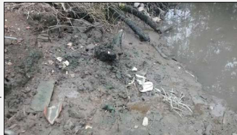
Figura 18: Unidade Geotécnica Solo Hidromórfico, com baixas propriedades geotécnicas em função do solo hidromórfico e da variação granulométrica.
