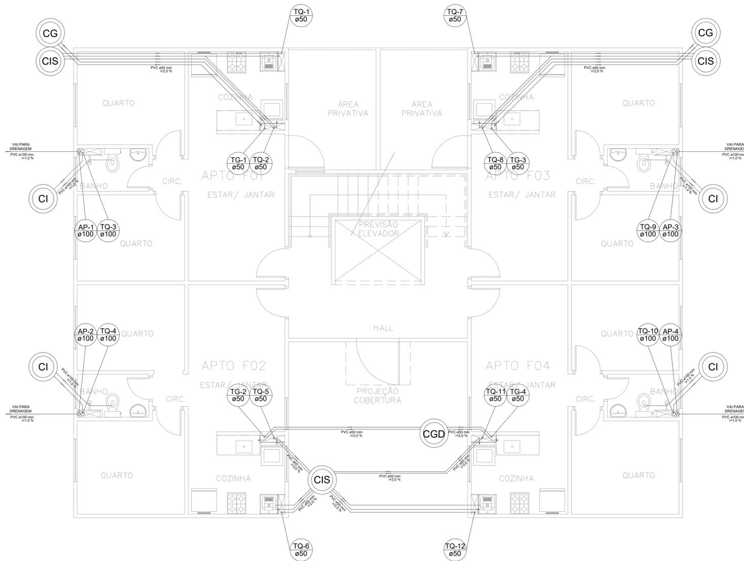
**PLANTA DE CAPTAÇÃO DE ESGOTO E ÁGUAS PLUVIAIS - PAV. TÉRREO**
