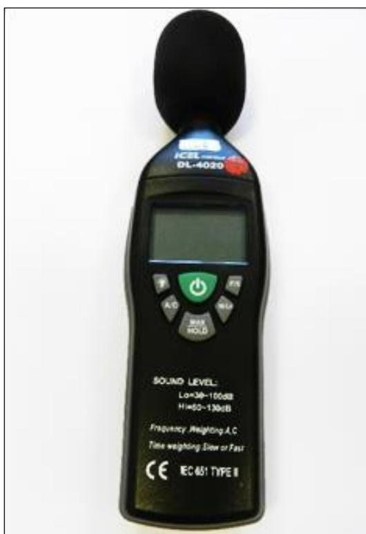
Figura 53: Medidor de pressão sonora utilizado durante as aferições. Fonte: DBio, 2018.
