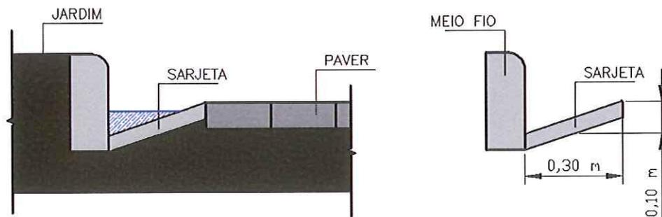
A vazão do maior trecho é de 0,014 m<sup>3</sup>/s e a vazão que a calha acima dimensionada suporta é de 0,017 m<sup>3</sup>/s, com isso concluímos que a calha dimensionada suporta a vazão exigida em projeto.
