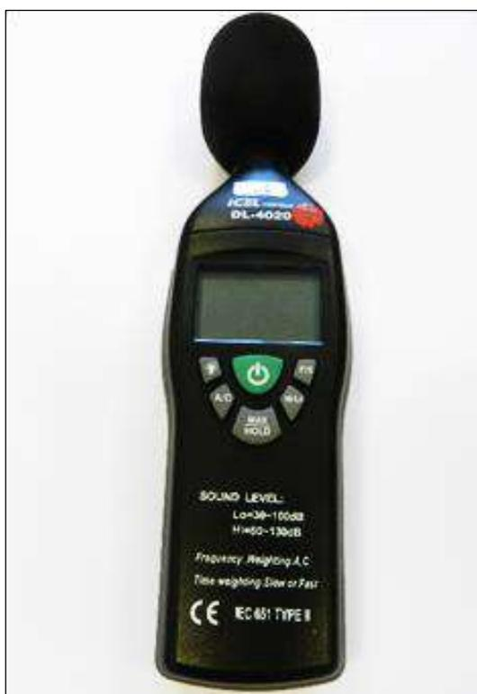
Figura 51: Medidor de pressão sonora utilizado durante as aferições. Fonte: DBio, 2018.
