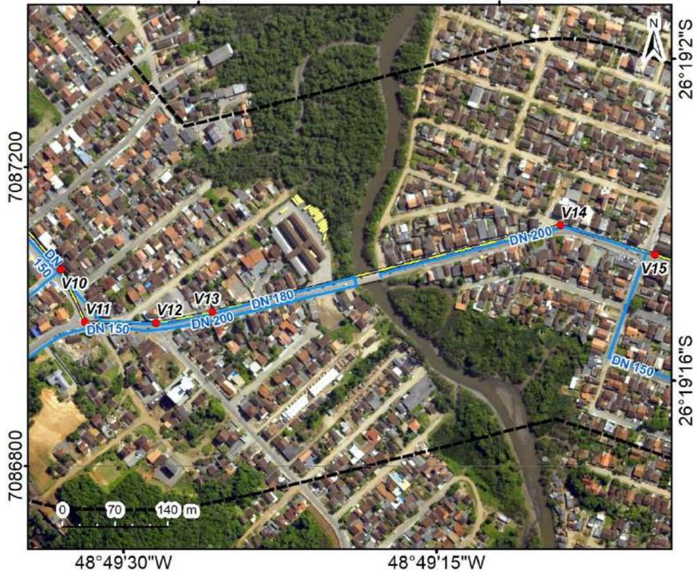
Figura 90 - Sobreposição de tubulações com a LD.
