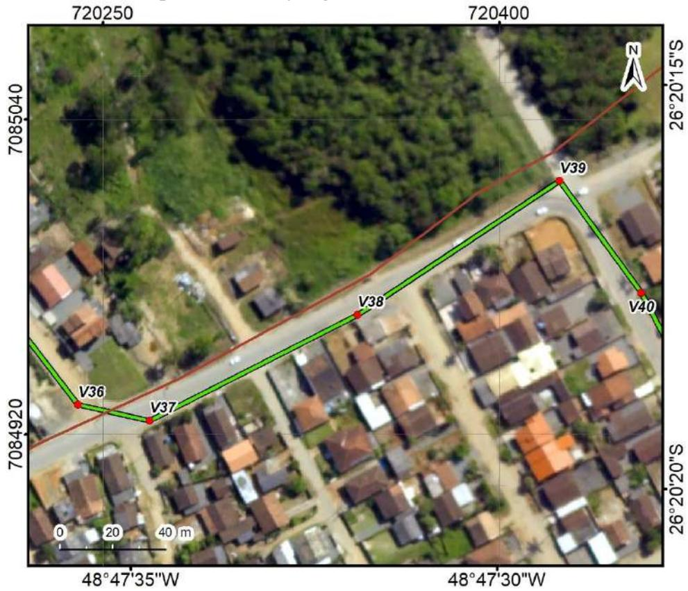
Figura 94 - Sobreposição da tubulação de recalque com a LD.
