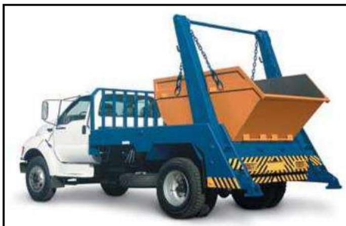
Figura 36 - Exemplo de caminhão poliguindastes utilizado para a movimentação das caixas estacionárias tipo "Brooks".
