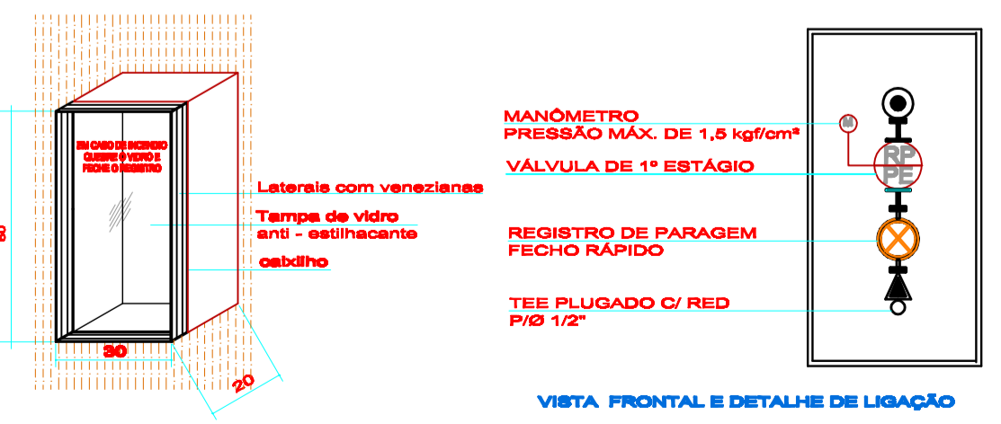
CONJUNTO CONTROLE E MANOBRAS CENTRAL DE GLP.
