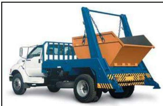
Figura 32 - Exemplo de caminhão poliguindastes utilizado para a movimentação das caixas estacionárias tipo "Brooks".
