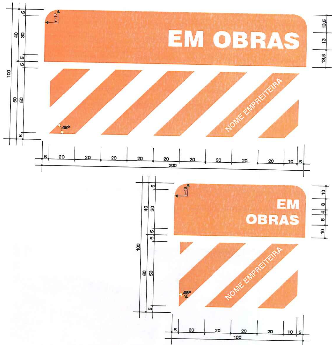
Figura 84: Placa de sinalização para período de obras.
