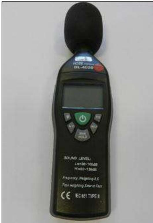
Figura 46: Medidor de pressão sonora utilizado durante as aferições.
