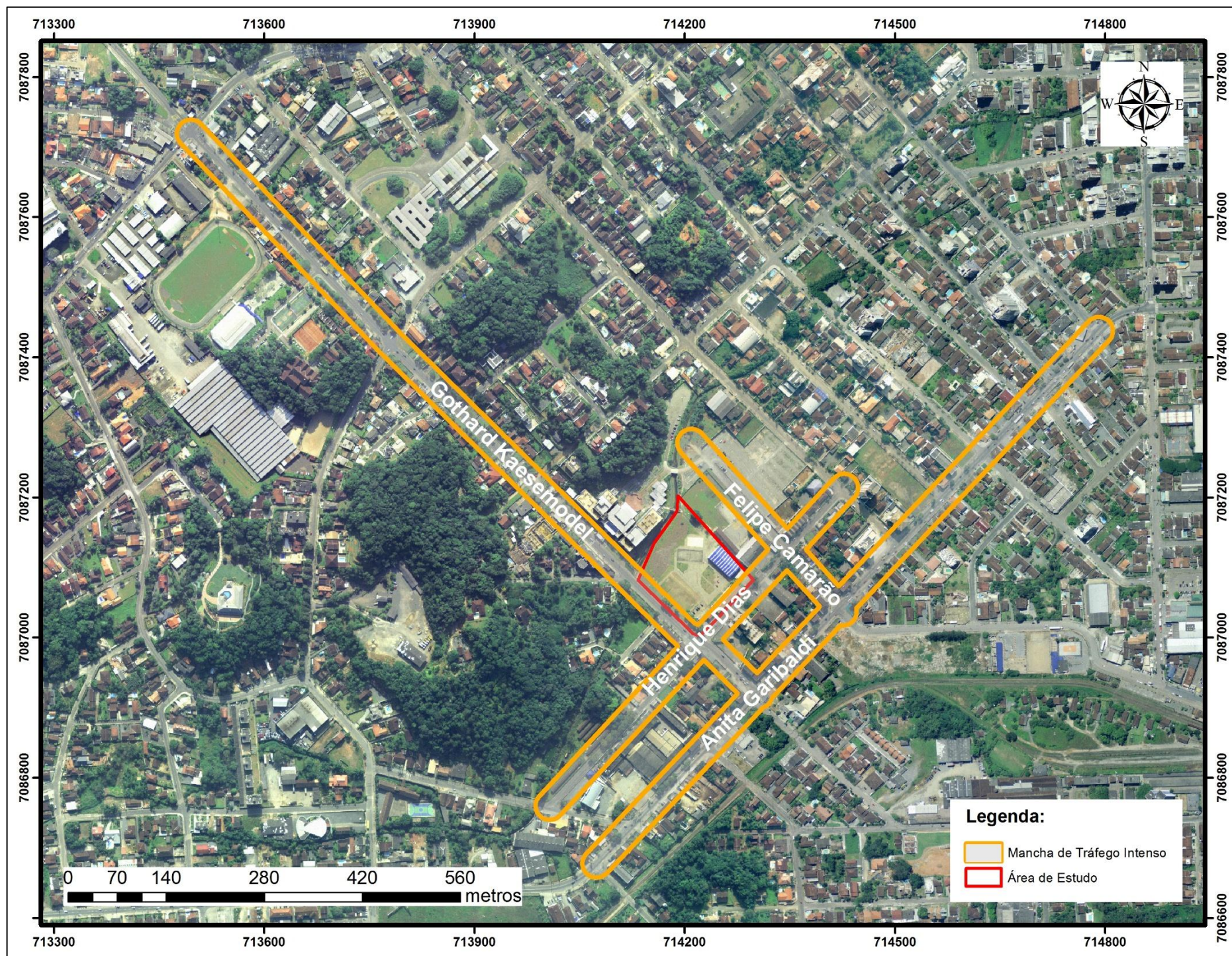
Figura 58 - Mancha do fluxo de tráfego nas vias próximas ao empreendimento.
