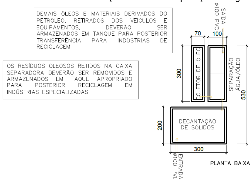
Figura 11 – Sistema de decantação de areia e separação de água e óleo.
